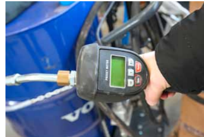
Die Füllpistolen mit Vorwahlmöglichkeit und Elektronikzähler kommen auf eine Messgenauigkeit von \pm 0,5\%
